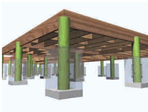
Figura 3 - 3: Fundación aislada, pilotes impregnados (C.C.A).
