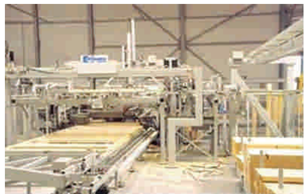
Figura 6 - 3: Industria especializada que muestra la estación en la que se arman los tabiques y se realizan las uniones de los elementos.
