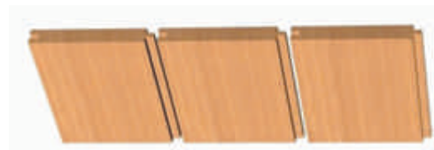
Figura 19 - 12: Molduras machihembradas con cantería rebajada como revestimiento de cielo.
